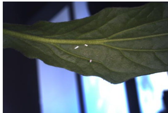
De camera-opstelling die is ontwikkeld, met actieve belichting voor het detecteren van witte vlieg onder het blad. Rechts een opname.
