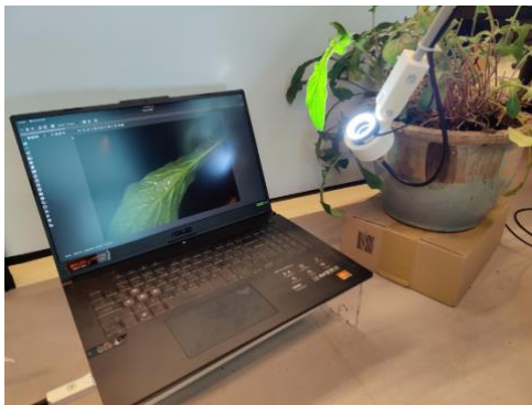
De camera-opstelling die is ontwikkeld, met actieve belichting voor het detecteren van witte vlieg onder het blad. Rechts een opname.
